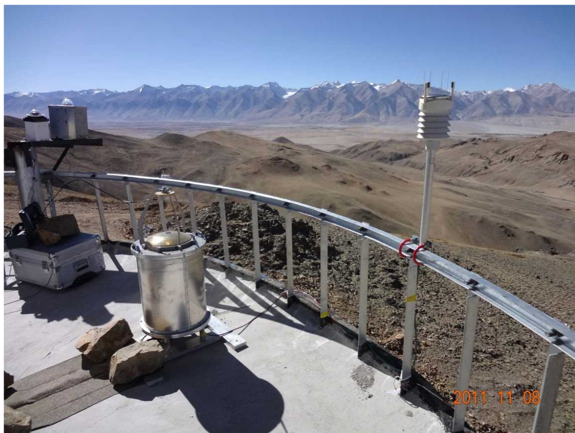
図3. ガー山に設置された赤外線雲モニタ装置（手前の円筒形状）と気象センサー（右側ロットの上）。左の2台のカメラは全天カメラ（中国）奥の山の向こうにヒマラヤ連山がある。
