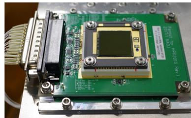
Fig.9: 浜松ホトニクス製InGaAs検出器
