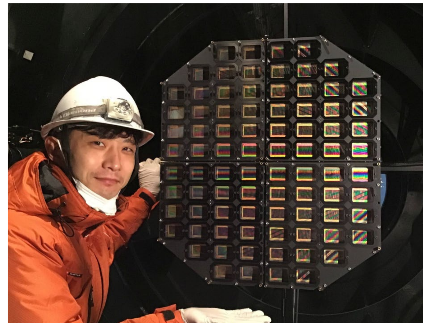
望遠鏡焦点に搭載されたトモエゴゼンカメラ 84台のCMOSセンサが並ぶ
