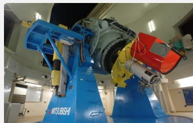
なゆた望遠鏡 近赤外線3バンドで同時観測 (J:1.253 \mu m, H:1.632 \mu m, Ks:2.146 \mu m) (← 西はりま天文台 より引用)
